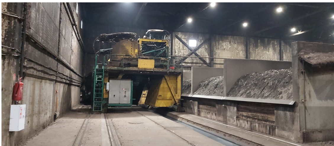
17 pav. Atliekų mobilusis vartytuvas „starto“ ruože prie atliekomis užpildytųjų „tranšėjų“ – šiuo atveju statinio ašių „19“ ir „2B“ sankirtoje, 2025 m. spalio 14 d.
