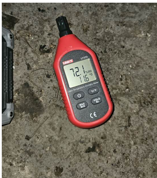
90 pav. Statinio dalyje tarp ašių „20“–„2P“ ir „20“–„21“ grindų lygyje išmatuota oro temperatūra ir aplinkos drėgmė (nuotrauka kairėje) ir 10 m aukštyje po stogu išmatuota oro temperatūra ir aplinkos drėgmė (nuotrauka dešinėje)
