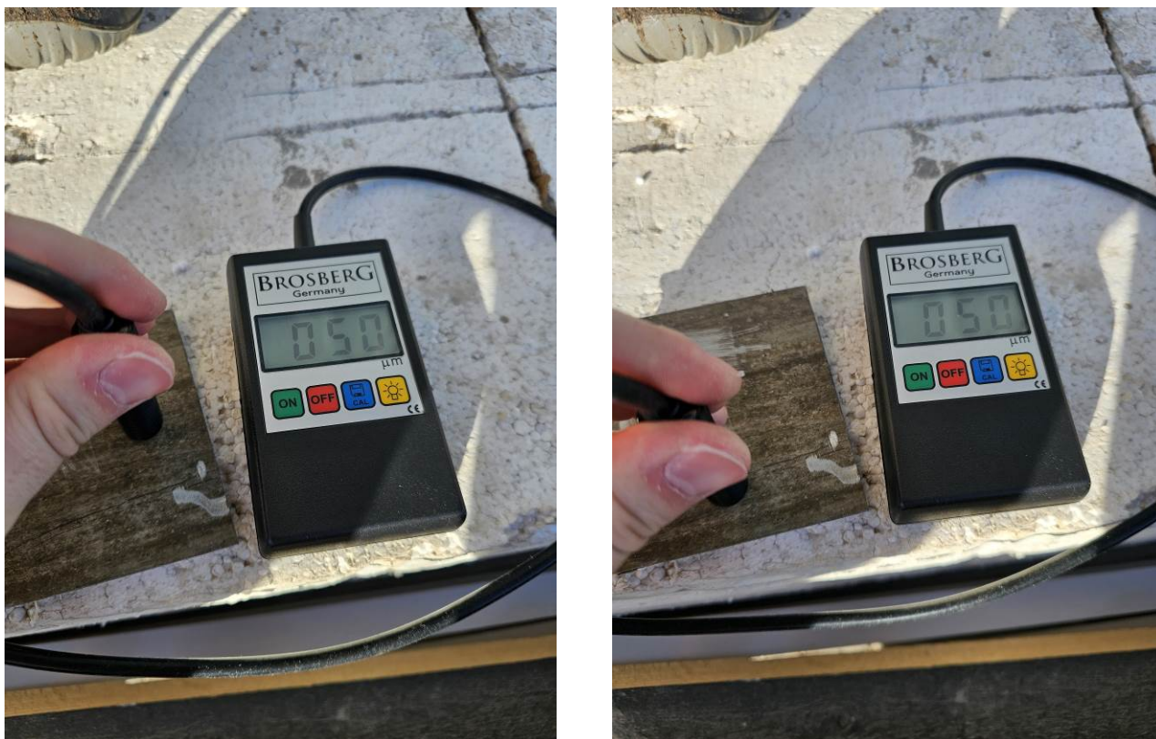
88 pav. Daugiasluoksnės sieninės plokštės vidinio lakšto dažų sluoksnio storio matavimai (iš sienos išpjautas skardos fragmentas)
