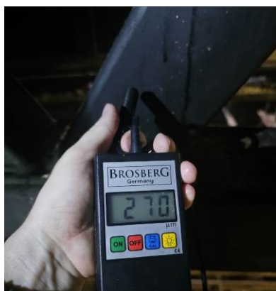
93 pav. Stogo santvarų dažų sluoksnio storio matavimai: 270 ir 630 \mu\text{m} . 2023 m. daryta nuotrauka
