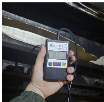
92 pav. Profiliuotojo pakloto dažų sluoksnio storio matavimai: 60 ir 70 \mu\text{m} . 2023 m. daryta nuotrauka
