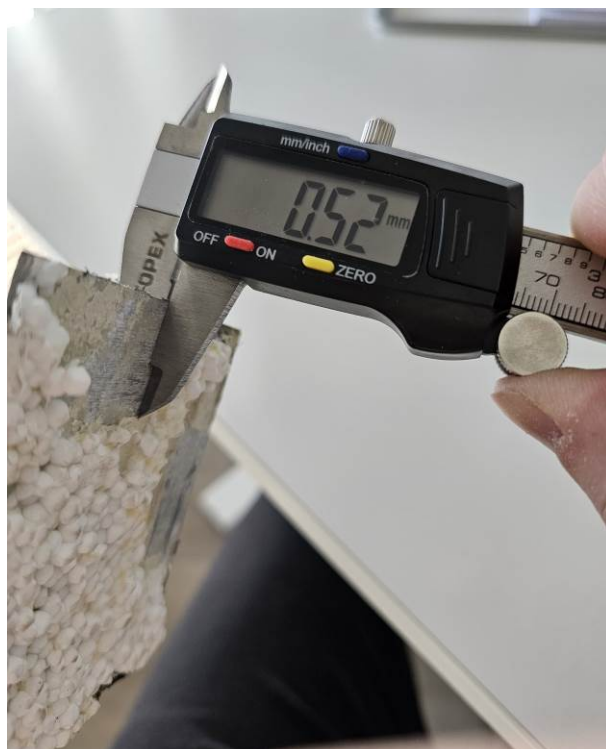
87 pav. Daugiasluoksnės sieninės plokštės vidinio plieninio lakšto storio 0,52 mm matavimas (iš sienos išpjautas skardos fragmentas)
