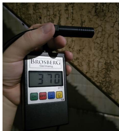
94 pav. Ryšių tarp kolonų dažų sluoksnio storio matavimai: 230 ir 370 \mu\text{m} . 2023 m. daryta nuotrauka
