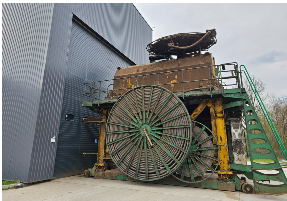
116 pav. Vartytuvas prie techninio aptarnavimo 1-3 patalpos lauko vartų, atliekų vartymo mechanizmas. 2023 m. balandžio mėn.
