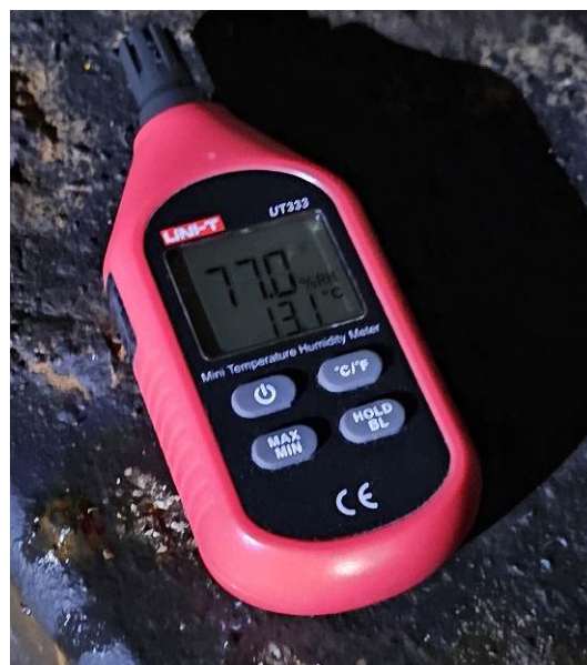
90 pav. Statinio dalyje tarp ašių „20“–„2P“ ir „20“–„21“ grindų lygyje išmatuota oro temperatūra ir aplinkos drėgmė (nuotrauka kairėje) ir 10 m aukštyje po stogu išmatuota oro temperatūra ir aplinkos drėgmė (nuotrauka dešinėje)
