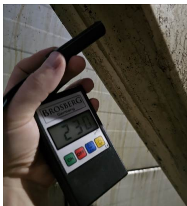
94 pav. Ryšių tarp kolonų dažų sluoksnio storio matavimai: 230 ir 370 \mu\text{m} . 2023 m. daryta nuotrauka
