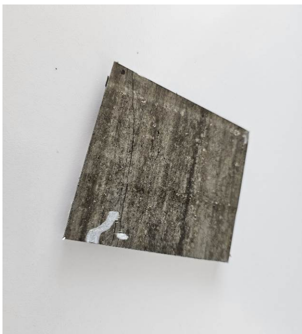
86 pav. Sieninių plokščių sudėties tikrinimas ašyje „2P“ (iš sienos išpjautas skardos fragmentas)
