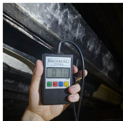
92 pav. Profiliuotojo pakloto dažų sluoksnio storio matavimai: 60 ir 70 \mu\text{m} . 2023 m. daryta nuotrauka
