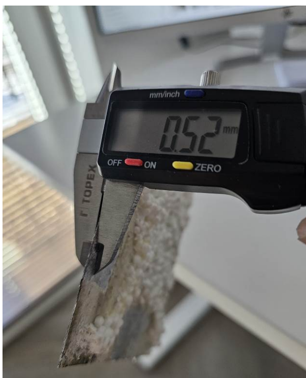
87 pav. Daugiasluoksnės sieninės plokštės vidinio plieninio lakšto storio 0,52 mm matavimas (iš sienos išpjautas skardos fragmentas)
