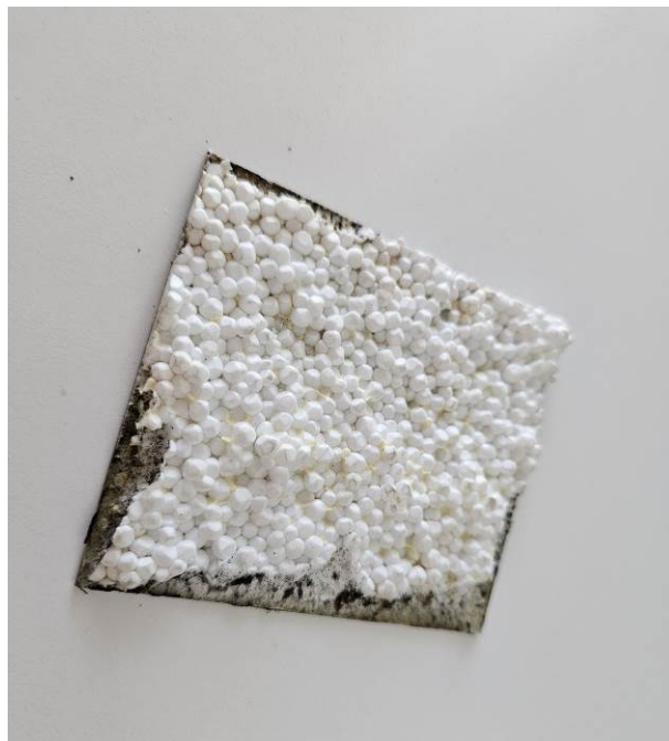
86 pav. Sieninių plokščių sudėties tikrinimas ašyje „2P“ (iš sienos išpjautas skardos fragmentas)
