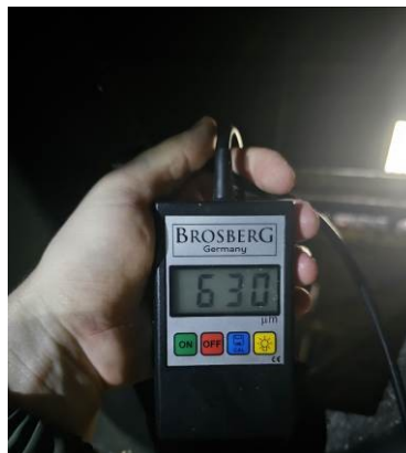
93 pav. Stogo santvarų dažų sluoksnio storio matavimai: 270 ir 630 \mu\text{m} . 2023 m. daryta nuotrauka
